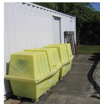
Tambores almacenados al aire libre en contención de derrames de tambores cubiertos
