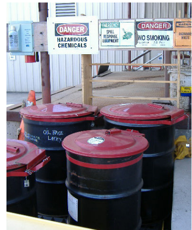
Tambores sobre palet de contención en zona exterior cubierta
