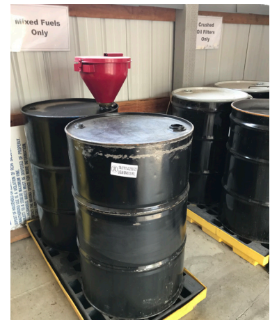
Tambores sobre palet de contención en zona interior
